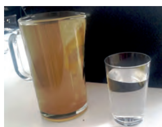
Anlagenwasser vor und nach der Ultrafiltration
