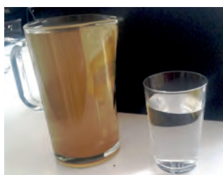
Anlagenwasser vor und nach der Ultrafiltration
